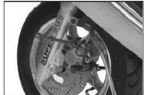
Aperte a válvula de escoamento para o torque especificado e desconecte o cano.
