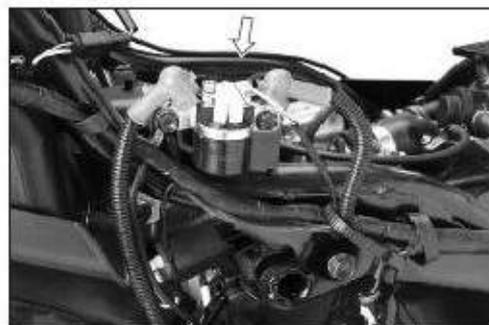
Aplique 12 volts aos terminais (1) e (2), verifique a condutividade entre os terminais positivo e negativo.
