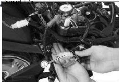
Use um multímetro de bolso para medir a voltagem entre os três fios de contato. Caso o multímetro indique abaixo do valor especificado, inspecione a condutividade da bobina estatora do gerador.
